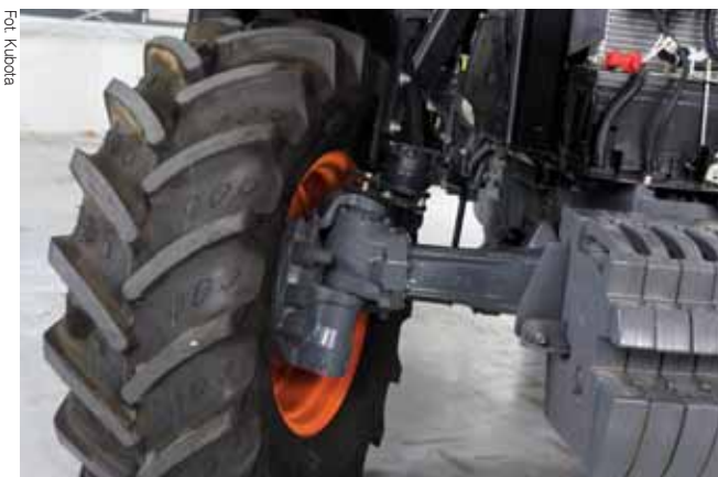
Przekładnia kątowna zastosowana na osi przedniej. Jej zaletą jest brak ograniczenia mocy podczas skrętu
