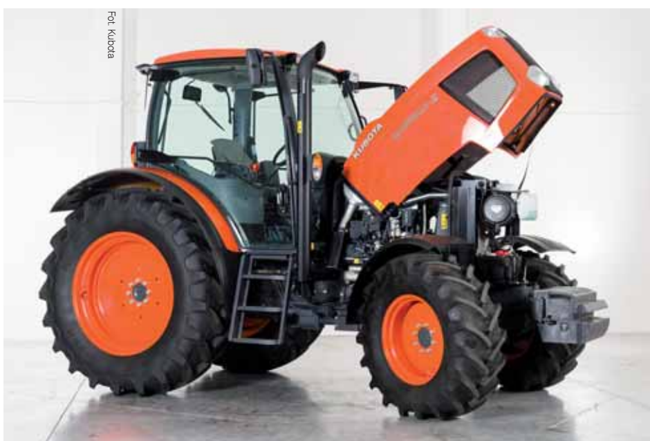
Ciągnik M128GX-II. Napędzany jest oszczędnym, 4-cylindrowym silnikiem Kubota V6108-CR-TIE4 o mocy 133,4 KM
